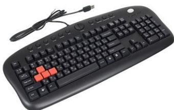
**Клавиатура** – устройство, которое позволяет пользователям вводить текст и команды нажатием клавиш с символами и специальных функциональных клавиш.
