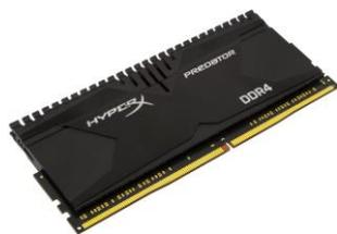
**Оперативная память RAM** – это энергозависимая часть системы компьютерной памяти. Это означает, что информация в ней хранится временно до тех пор, пока устройство (*компьютер, ноутбук и т.д.*) работает, то есть подключено питание.
