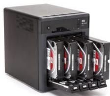
**Сетевое хранилище (NAS)** – устройства NAS, которые позволяют создавать сетевые хранилища для обмена данными между различными устройствами в домашних или офисных сетях.
