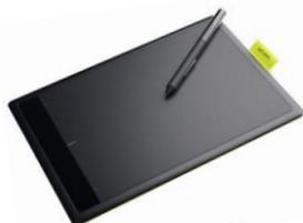
**Графический планшет** – устройство, которое позволяет пользователям вводить рукописный ввод или графические изображения с помощью специального стилуса или ручки и записывать рисунки или рукописный текст.
