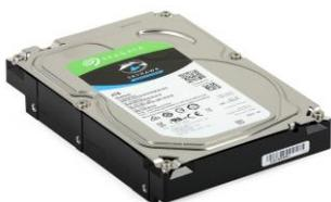
**Жесткие диски (HDD)** – это устройства на магнитных дисках для хранения данных. Они имеют большие объемы памяти и часто используются в настольных компьютерах и серверах.
